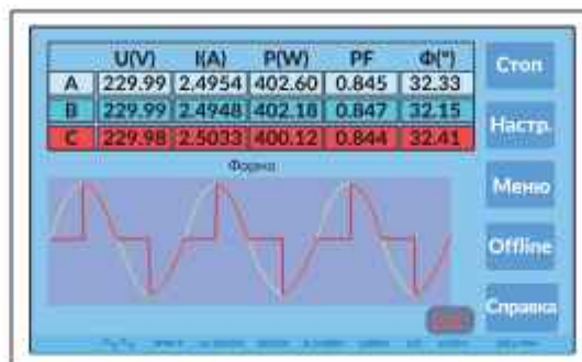
Рисунок 4.2.3.5.4. Окно режима формы сигнала (нечётные гармоники) блока управления HS-6633
