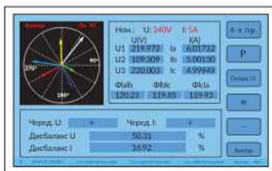
Рисунок 4.3.3.3. Экран векторной диаграммы в режиме фI
