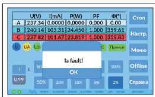
Рисунок 4.2.2.4. Сообщение о неисправности по току фазы А на дисплее блока управления HS-6633
