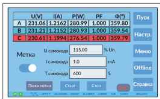
Рисунок 4.2.3.4.2. Окно режима проверки самохода (поиск метки) блока управления HS-6633
