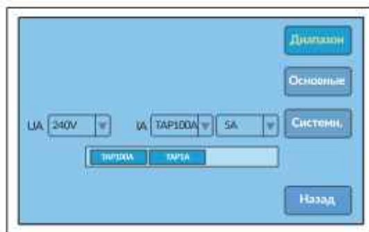
Рисунок 4.3.6.5. Окно настроек диапазона напряжений
