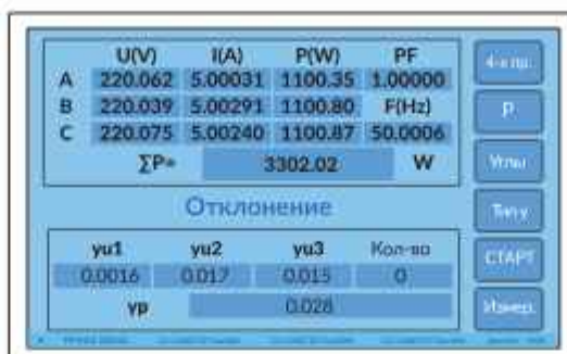
Рисунок 4.3.2.1. Экран измерений активной мощности P эталонного счётчика 3ф4пр, схема включения
