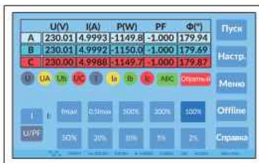
Рисунок 4.2.2.3. Главное окно блока управления HS-6633 (задание обратного направления I)
