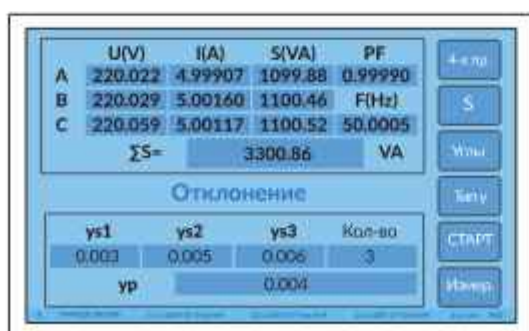
Рисунок 4.3.2.4. Экран измерений полной мощности S эталонного счётчика
