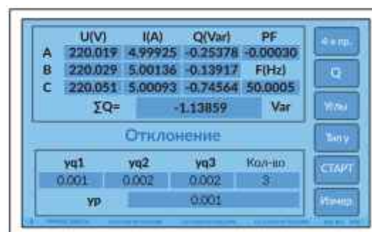
Рисунок 4.3.2.3. Экран измерений реактивной мощности Q эталонного счётчика
