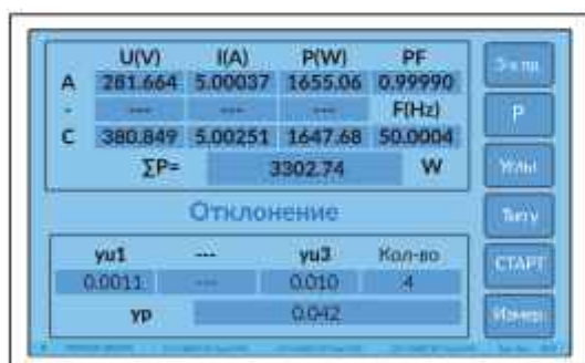
Рисунок 4.3.2.2. Экран измерений эталонного счётчика 3ф3пр, схема включения
