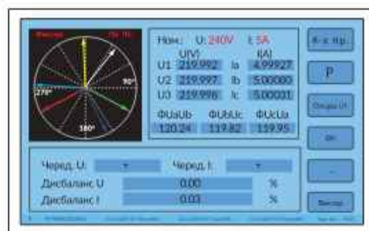
Рисунок 4.3.3.2. Экран векторной диаграммы в режиме фU
