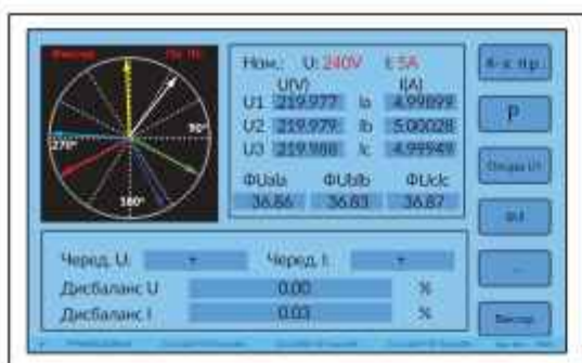
Рисунок 4.3.3.1. Экран векторной диаграммы в режиме фU
