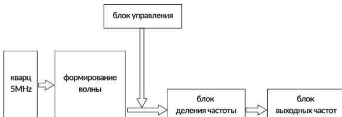
Рисунок 4.4.3. Схема блока проверки точности хода часов HS-1012C
