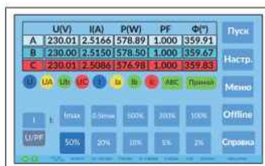
Рисунок 4.2.1.1. Главное окно блока управления HS-6633
